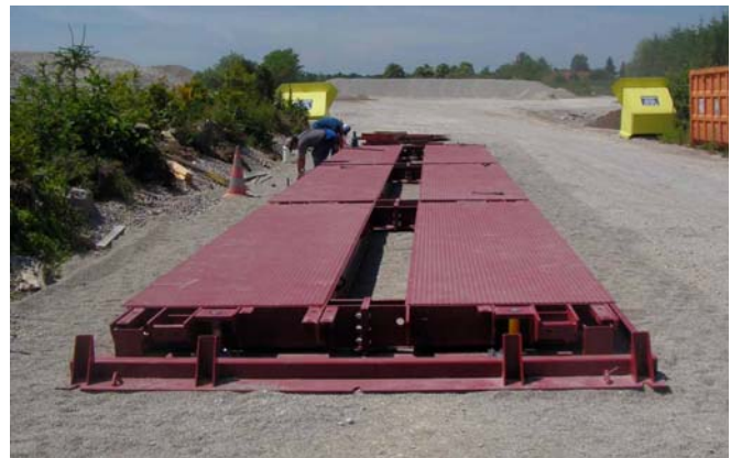
Einfacher Aufbau. Wartungs- und Reinigungszugang durch mittleren Spalt in gesamter Waagenlänge, die Wägezellen sind von oben zugänglich.
