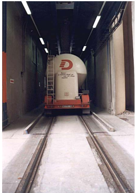
Unsere kombinierte Gleis-Straßenfahrzeugwaage „KGW“ in Aktion
