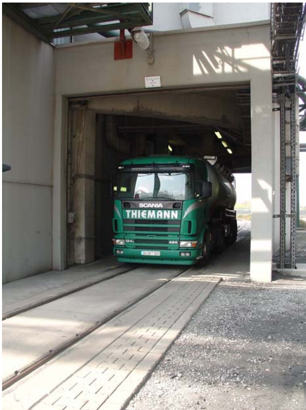
Unsere kombinierte Gleis-Straßenfahrzeugwaage „KGW“ in Aktion
